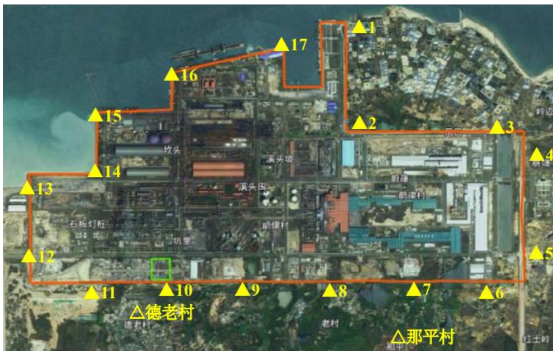
图 5.4-1 湛江钢铁厂界噪声监测布点示意图
