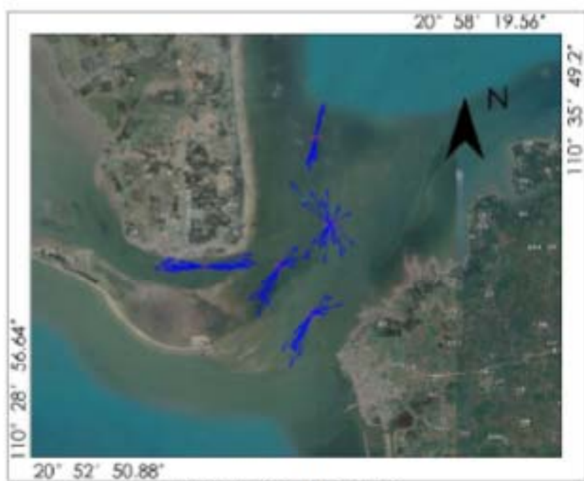
附图 3-3d 流速矢量图 (0.6H 层)
