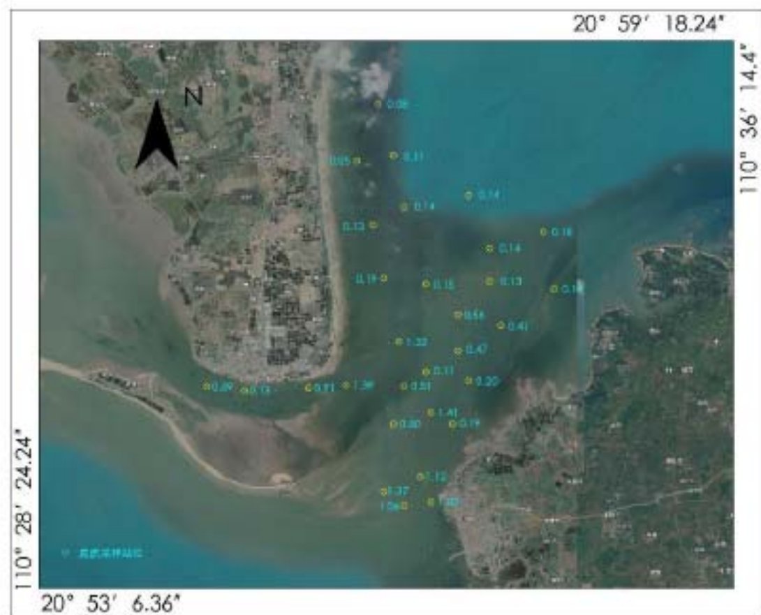
图 2.2.3-13a 表层沉积物中值粒径 (单位: mm)
