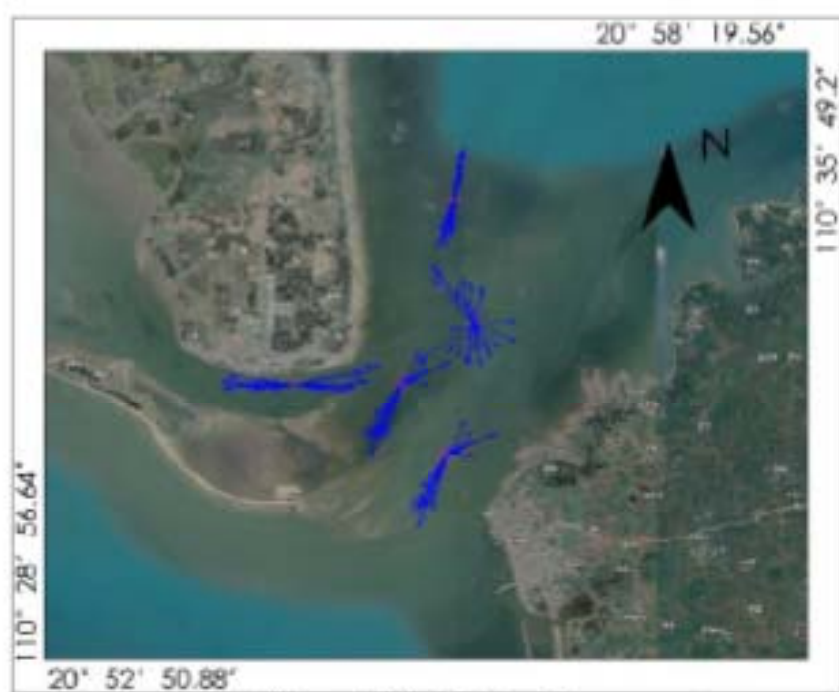
附图 3-3c 流速矢量图 (0.4H 层)
