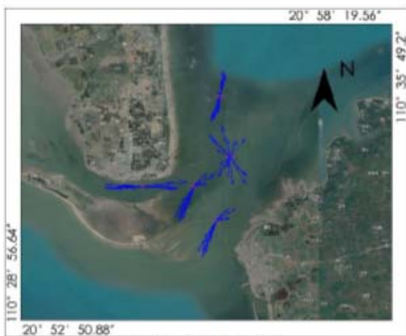
附图 3-3b 流速矢量图 (0.2H 层)
