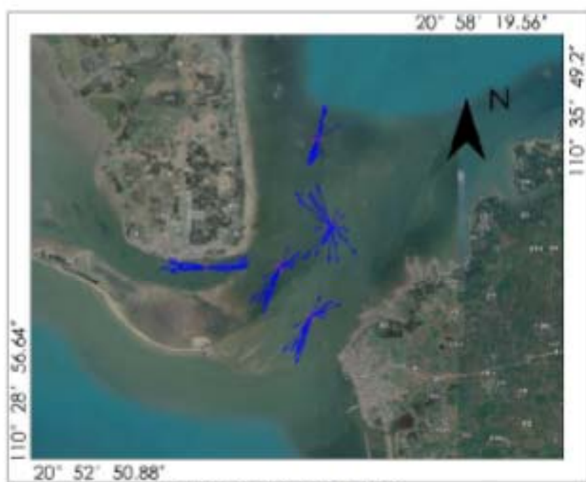
附图 3-3a 流速矢量图 (0.8H 层)
